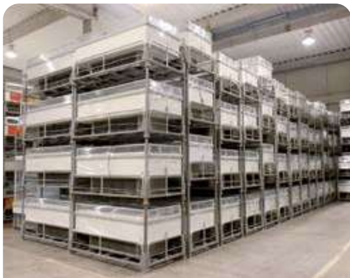
Système de gerbage des racks de protection
