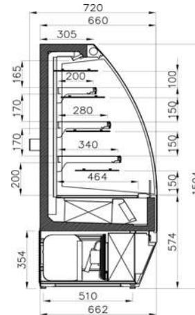
Semi-verticale, de profondeur réduite (690 mm), conçue pour la mise en valeur, la conservation et la vente des produits frais et des boissons. Des lignes arrondies et un faible encombrement au sol font de l'OPALINE SLIM, un outil particulièrement apprécié dans les petites surfaces de vente.
